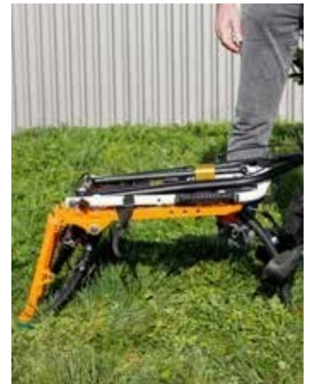
**3.** Sbloccare la levetta di sblocco (sotto la seduta) e ruotare la Joëlette appoggiandosi alle maniglie fino a quando i cuscinetti di supporto in gomma sono a contatto con il terreno.
