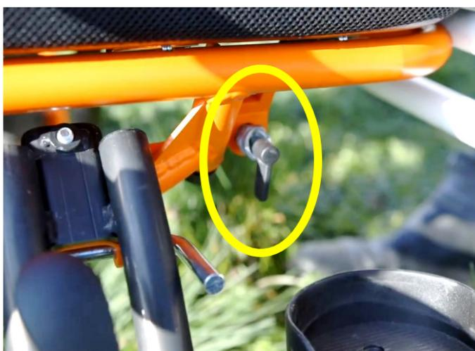
Posizione **rivolta in basso** (sbloccata) in fase di montaggio, stazionamento e smontaggio.
