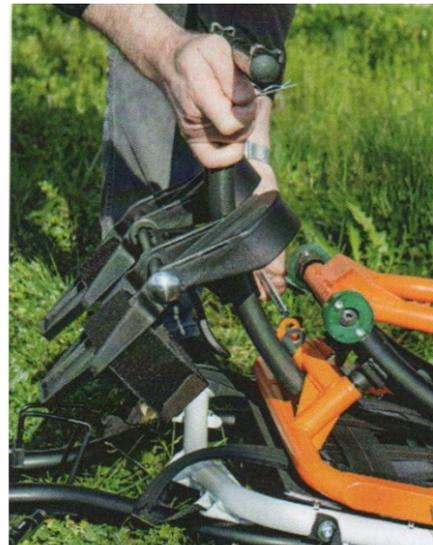
**2.** Prendere il poggiapiedi, posizionarlo sul suo supporto infilando la vite nell'apposita scanalatura e bloccarlo con il perno e la coppiglia.
