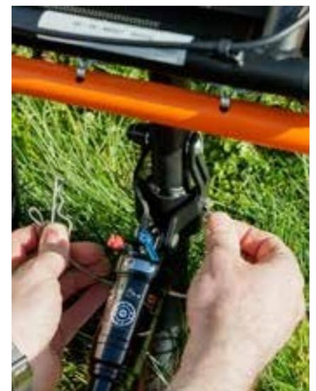
**4.** Rimuovere il perno indicato dalla freccia e aprire il forcellone in modo che i fori della staffa di montaggio dell'ammortizzatore coincidano con quelli del telaio.
