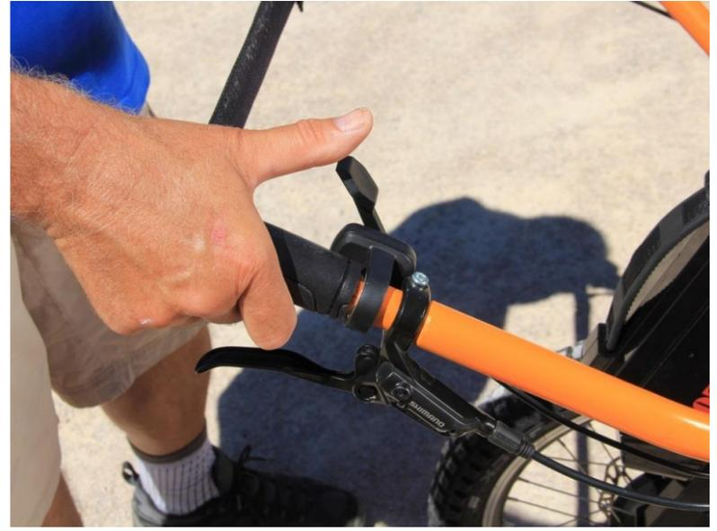
Azionare l'assistenza elettrica spingendo sull'apposita leva con gradualità e solo quando è necessario (dislivelli, forti pendenze, passaggi d'ostacoli...). La velocità è progressiva e può raggiungere un massimo di 6 km/h
