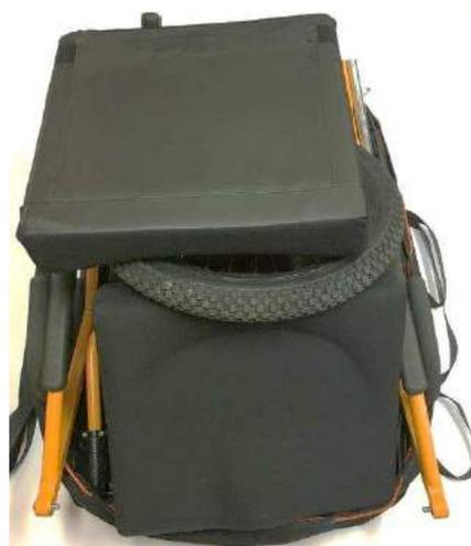
4 - Mettere il cuscino del sedere sotto la ruota e quello dello schienale sopra la ruota
