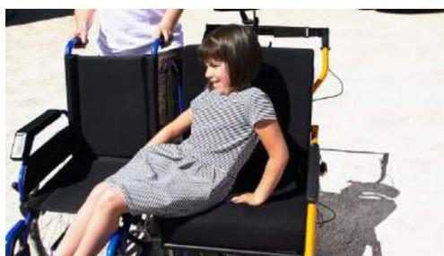
2. È anche possibile rimuovere uno dei due bracci anteriori (ovvero aspettare dall'inizio a montarlo) per effettuare un trasferimento laterale autonomo dalla sedia a rotelle alla Joëlette.
