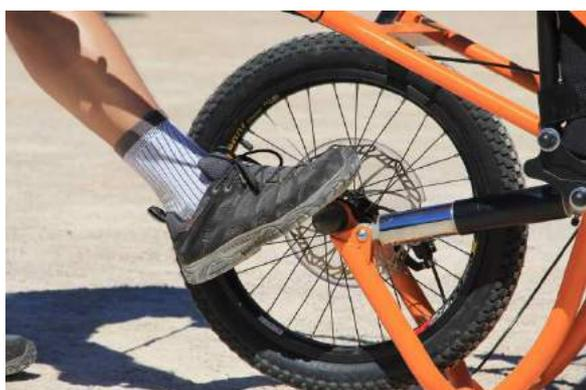
7. Quando il terreno è poco aderente, è possibile utilizzare il punto di appoggio situato sull'asse della ruota al fine di agevolare il sollevamento della Joëlette.
