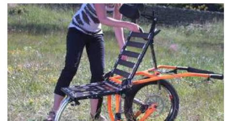
10- Ruotare lo schienale, agendo sulla levetta di regolazione, finché la ruota tocca il terreno
